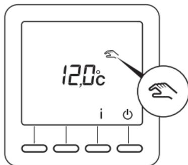
Sollte bei einer externen Programmunterbrechung das Symbol
