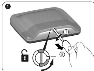
Entriegeln Sie das Gehäuse.
