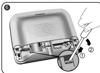
Con un destornillador, levante los 2 clips de la tapa superior.
