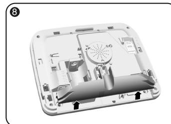
Entfernen Sie den Steckdosenschutz.
