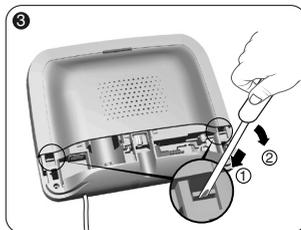
Con ayuda de un destornillador, levante los 2 clips que sujetan la tapa superior.
