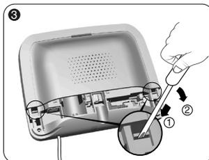
Usando un cacciavite, sollevate le 2 clip di fissaggio del coperchio superiore.
