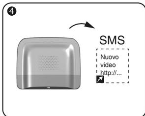
Il TYDOM 2.0 vi invia il link del video tramite SMS.
