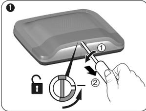
Entriegeln Sie das Gehäuse.
