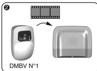
Czujnik DMBV TYXAL+ przekazuje wideo do nadajnika TYDOM 2.0.
