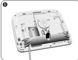
Entfernen Sie den Steckdosenschutz.
