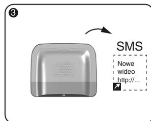
Nadajnik TYDOM 2.0 alarmuje użytkownika i wysyła SMS-em link do wideo.
