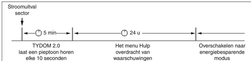
Als er een stroomstoring is, wordt de videotransmissie niet meer gegarandeerd. De overdracht van videolinks zal hervatten wanneer de netstroom wordt hersteld.
