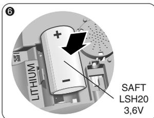
Inserite la pila rispettando la polarità.
